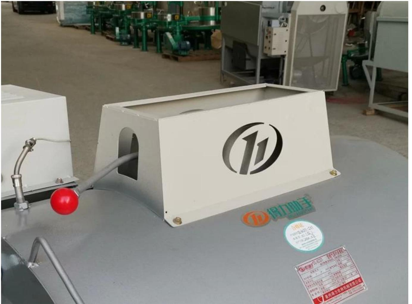
Desain sakelar pendingin atas, setelah pemrosesan pemangangan teh, buka katup pendingin, dapat mempercepat pembuangan panas
