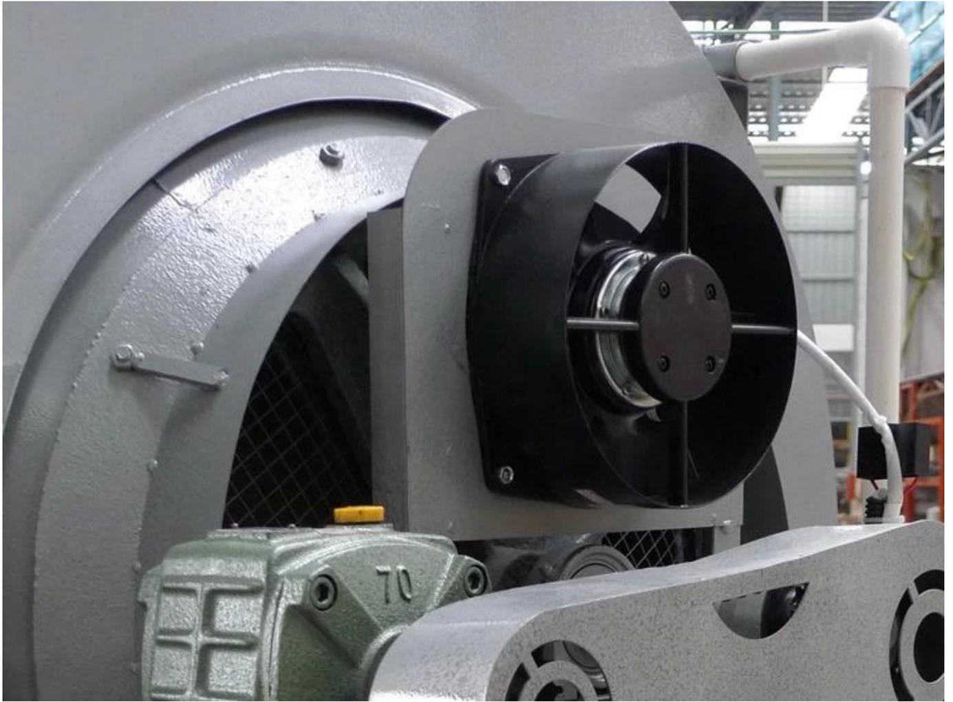
Sebuah kipas angin ditambahkan ke bagian belakang, yang dapat dinyalakan dan dimatikan secara manual, yang dapat dengan cepat meniup udara panas dan lembab di dalam mesin untuk mencegah teh menjadi pengap dan mempengaruhi rasa.
