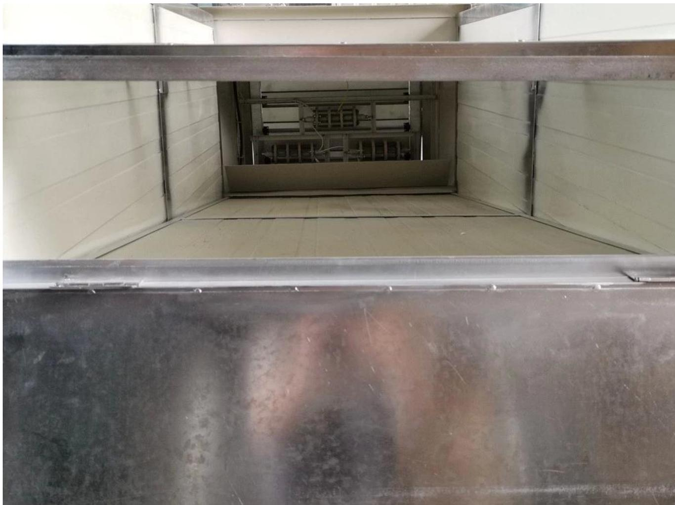
Pelat bawah tipe lereng dapat memastikan aliran udara yang cukup di bagian ekor untuk memastikan pemerataan pelayuan.
