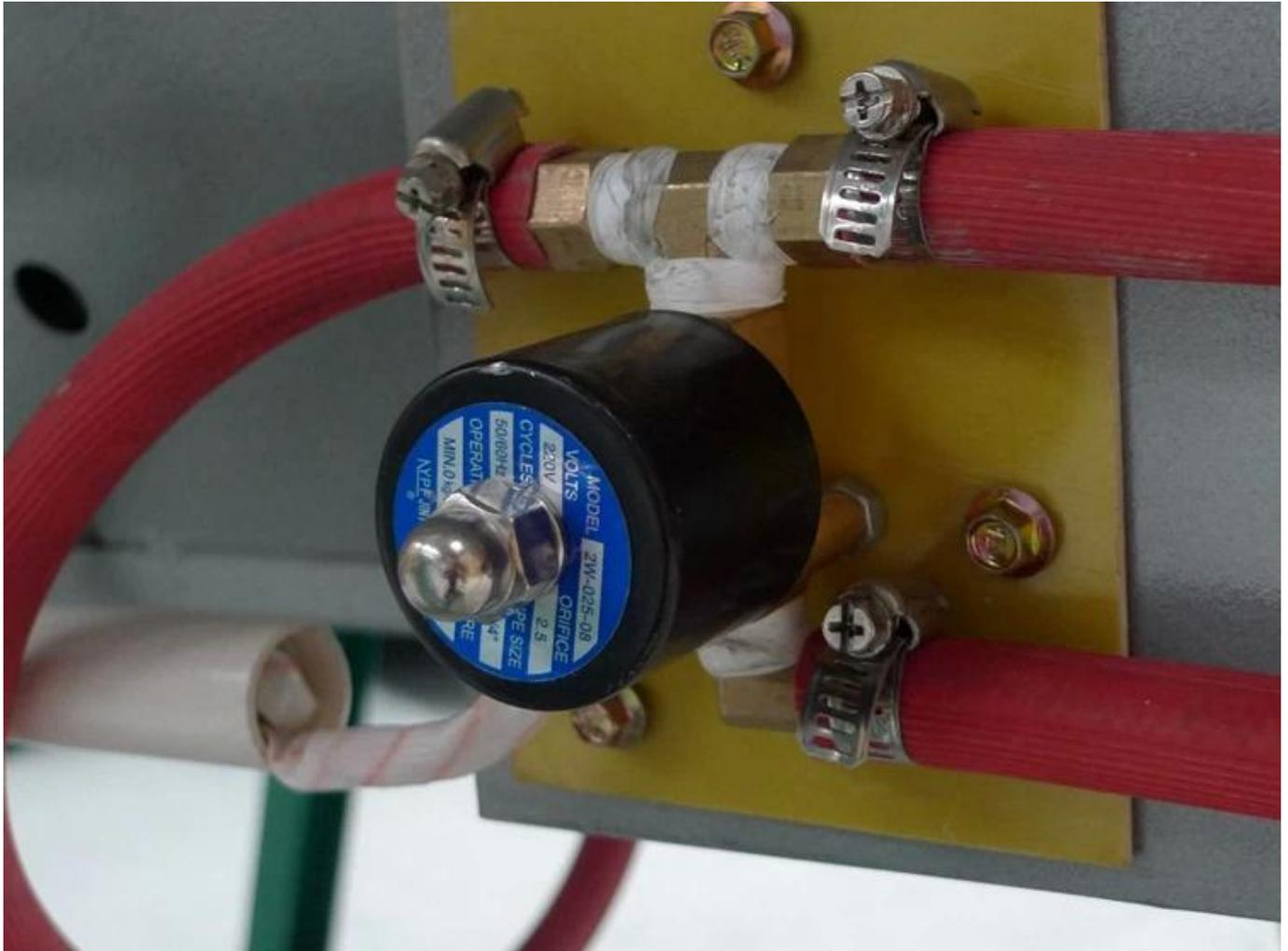
Desain katup solenoida otomatis, pemanasan otomatis mulai dan berhenti, katup solenoida secara otomatis menutup ketika suhu mencapai suhu yang disetel, dan mesin berhenti memanaskan. Ketika suhu lebih rendah dari suhu yang disetel, katup solenoida terbuka dan mesin memanaskan, yang dapat menghemat bahan bakar.
