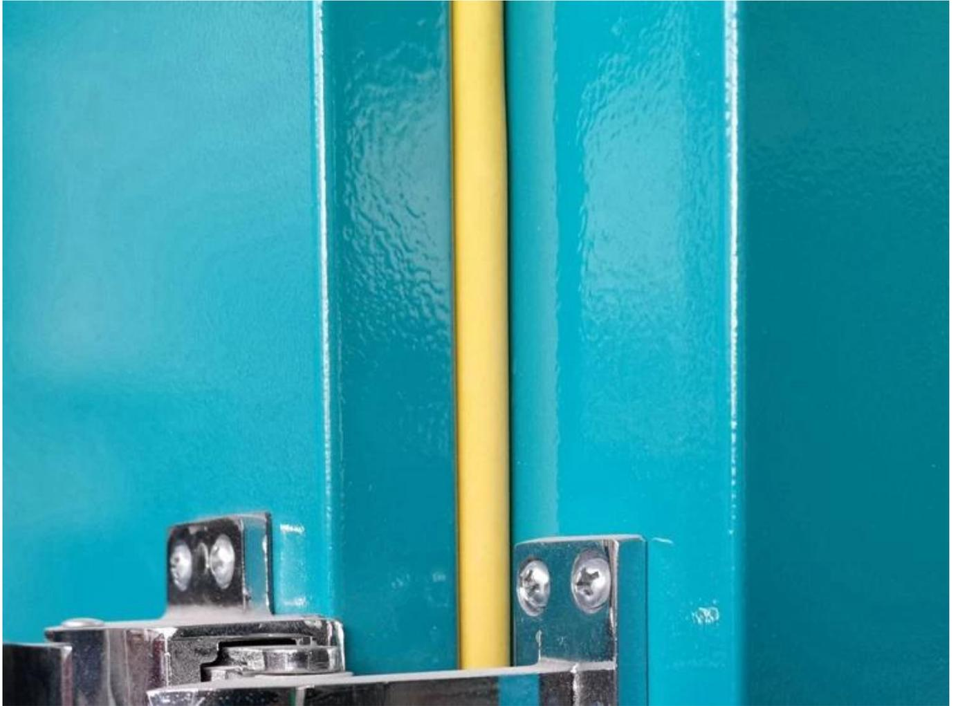
Pintu dilapisi dengan strip karet elastis tahan suhu tinggi, yang dapat menutup pintu mesin untuk mencegah udara panas dan kabut air keluar.
