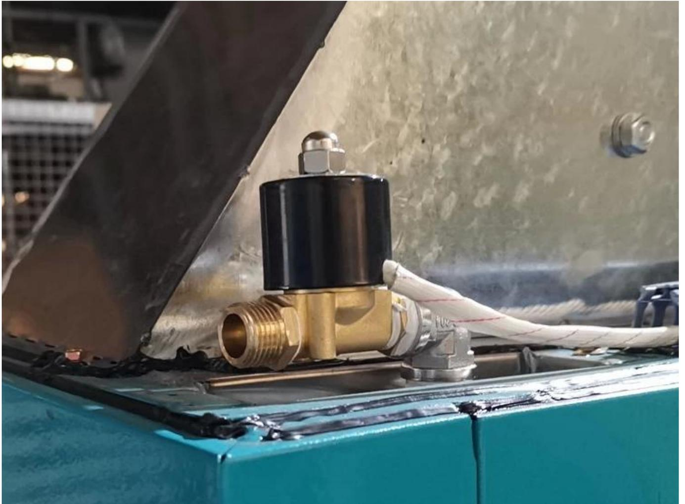
Desain katup solenoida memastikan bahwa air di dalam tangki disimpan pada ketinggian atomisasi terbaik.
