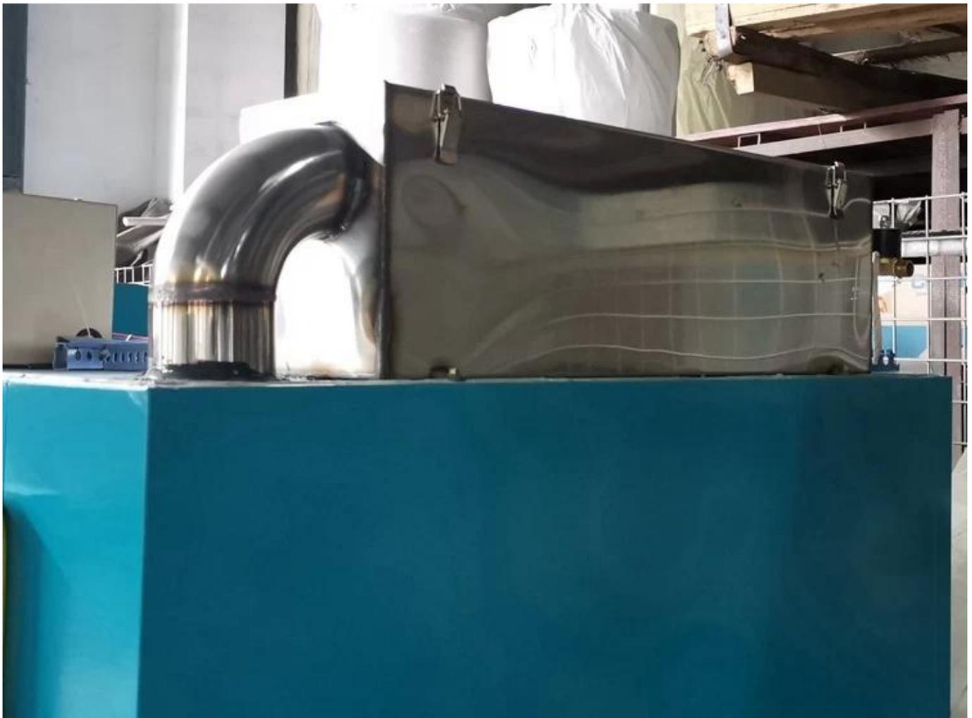
Tangki air dengan alat penyemprot dipasang di bagian atas, dan kabut air yang dikabutkan secara alami mengisi bagian dalam mesin fermentasi teh, dan fermentasi lebih seragam.
