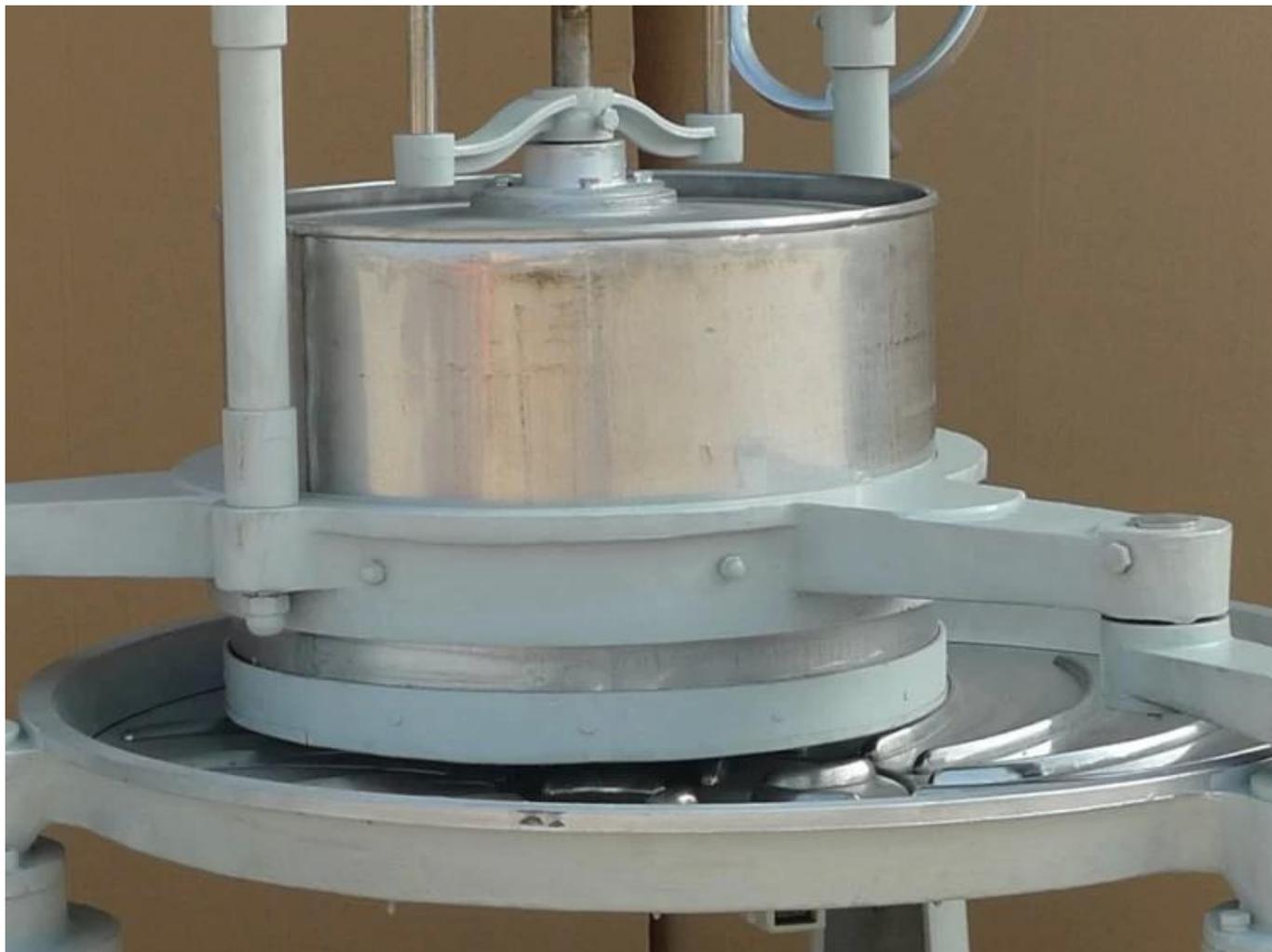
55 Jenis mesin rolling teh, diameter rolling barrel 55cm, tinggi 40cm, dapat memasukkan sekitar 35-40 kg teh di dalamnya, untuk teh hijau 1 jam dapat menggulung 35-350kg, untuk teh hitam 1 jam dapat menggulung 35-80 kg.
