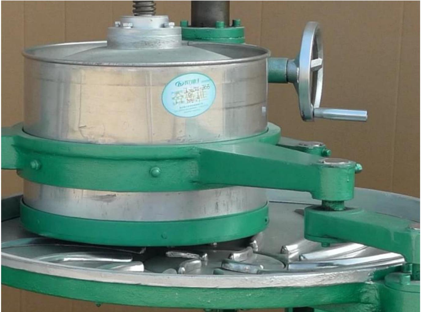
Jarak antara rolling barrel dan rolling disc setiap mesin berbeda untuk memastikan bahwa setiap mesin dapat membuat teh dengan kualitas terbaik.
