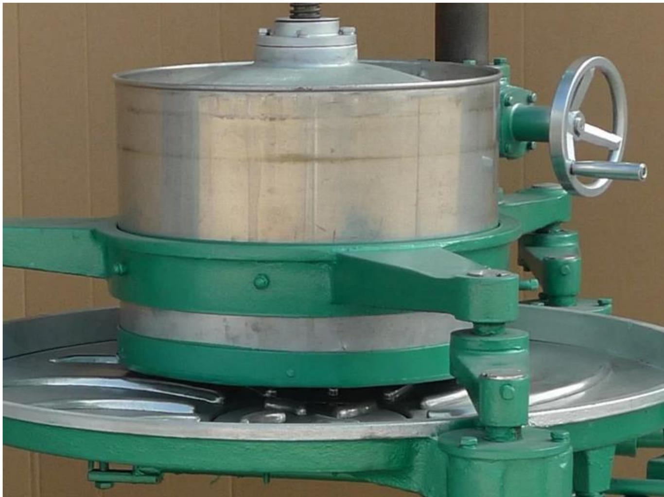
DL-6CRT-35 tea roller table's barrel terbuat dari SS304, diameter tong 35cm, tinggi 26cm, kapasitas sekitar 8 kg per batch.
