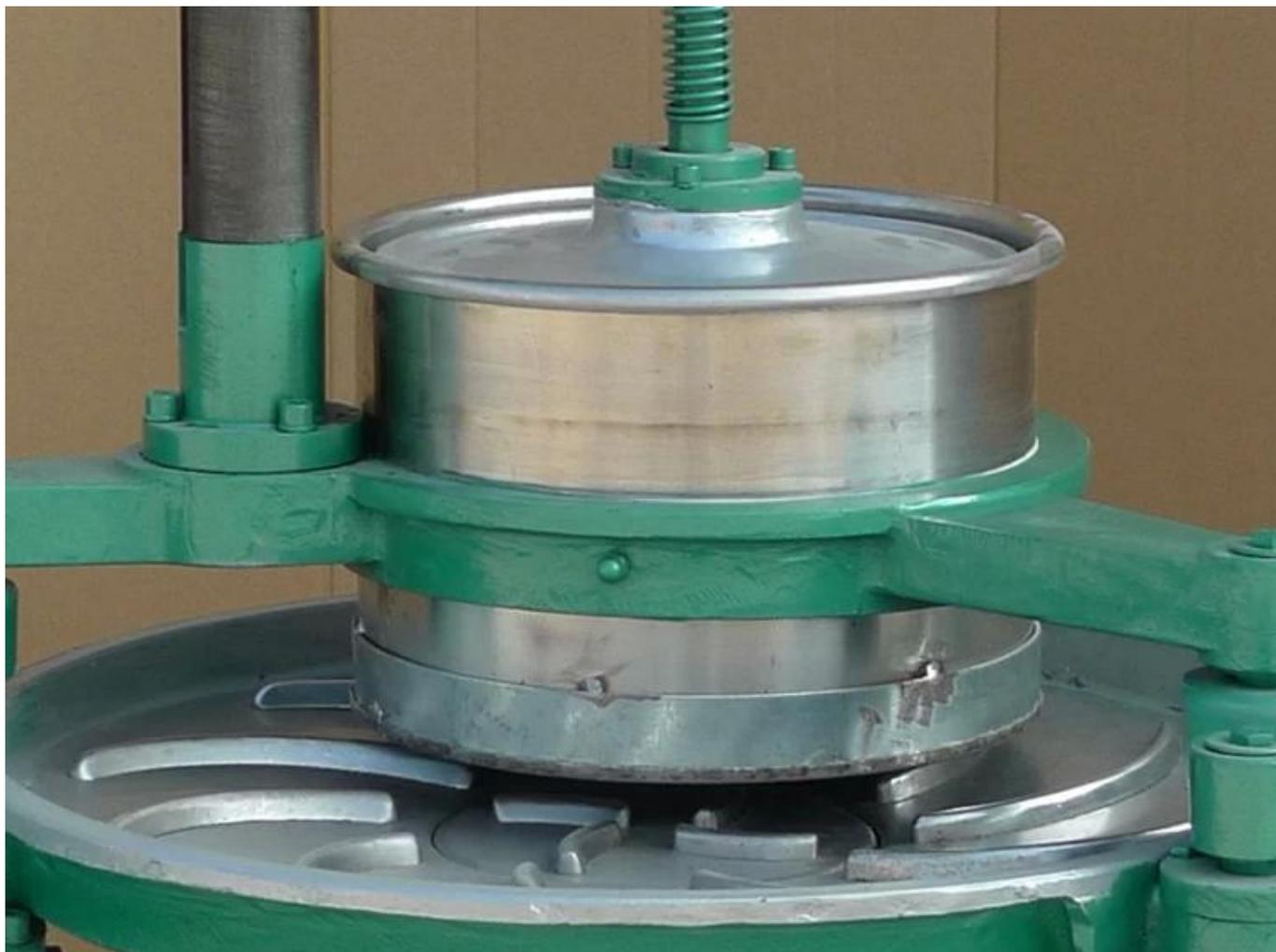
DL-6CRT-25 mesin penggulung teh diameter drum 25cm, tinggi 18cm, dapat menempatan sekitar 3kg per batch, untuk pengolahan teh hijau, kapasitas 3-30kg per jam, untuk pengolahan teh hitam, kapasitas 3-6 kg per jam.
