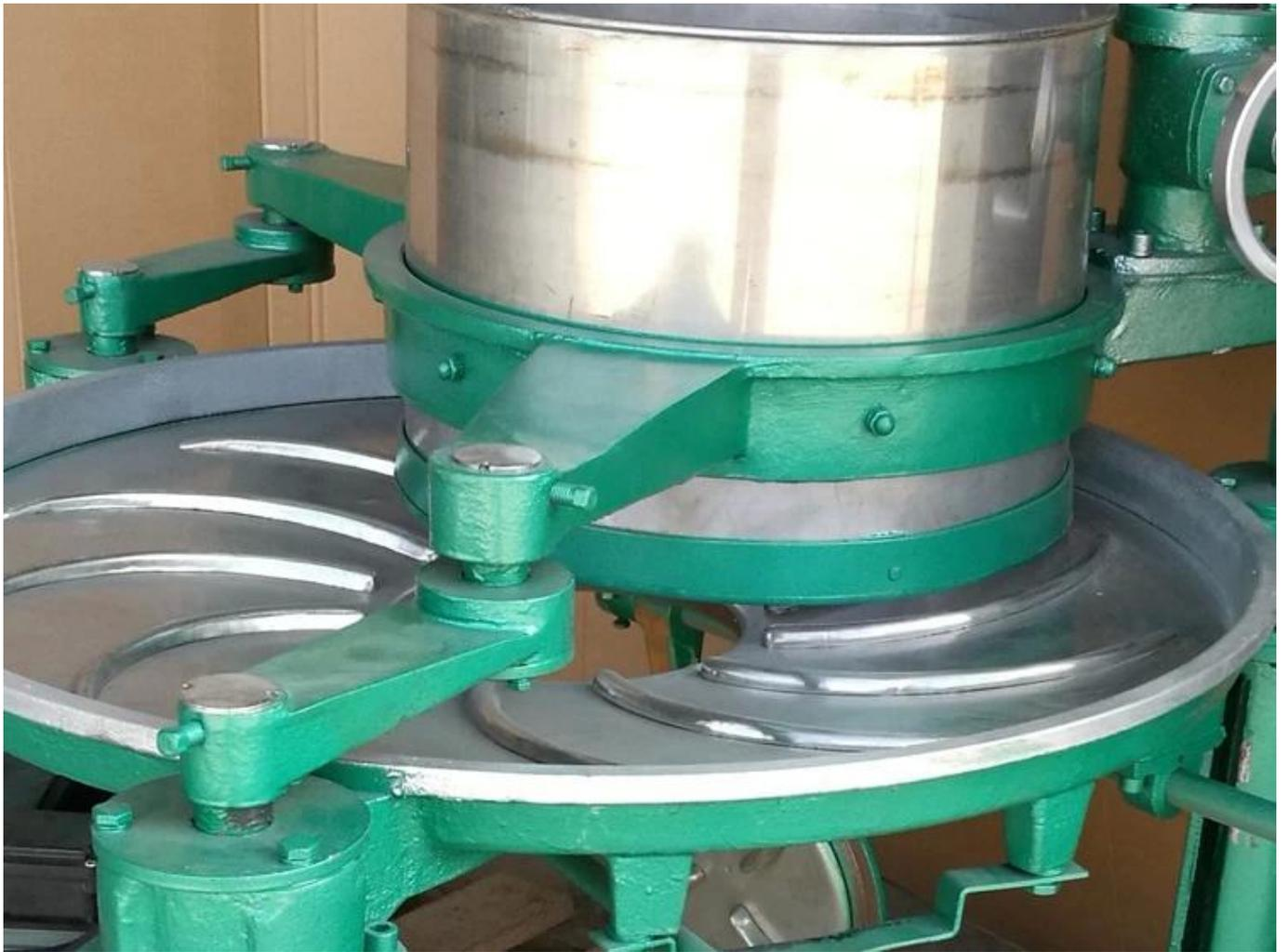
Rolling barrel, rolling disc, dan rolling bar semuanya terbuat dari stainless steel, yang higienis dan ramah lingkungan.
